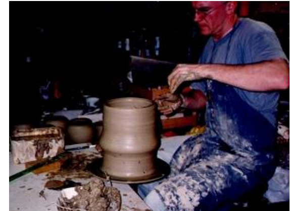
Az edény falának felhúzása.
