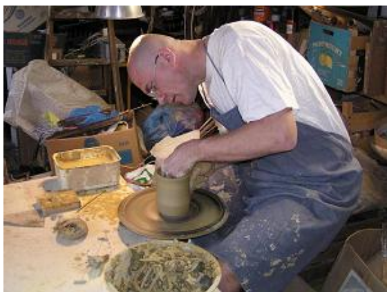
Az edény falának felhúzása.
