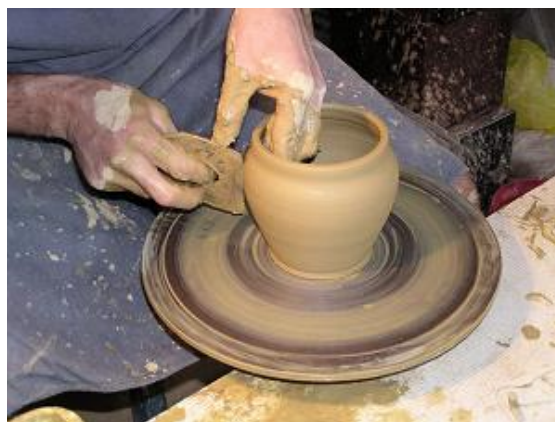
A has kialakítása II.
