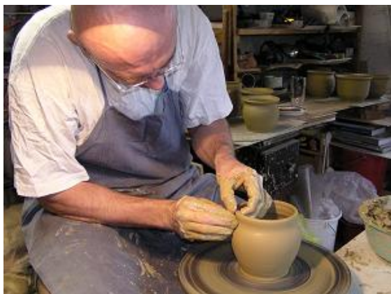
A száj kialakítása I.
