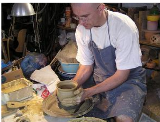
Levétel szárazra törölt tenyerekkel, hogy az edény ki ne csússzon a kezünkből.
