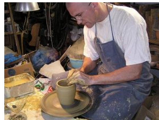
A száj kialakítása. A kezdetleges kialakítás formája miatt az edény teteje merevebbé válik, jobban tartja magát, míg a hasat alakítom.
