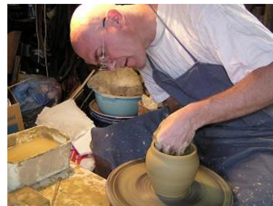
A has kialakítása III.
