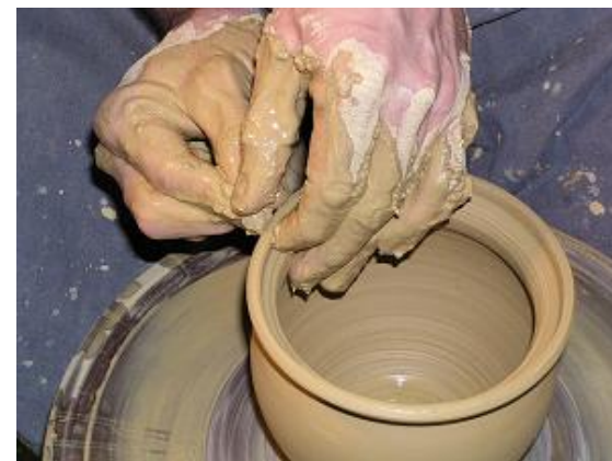
A száj kialakítása III.
